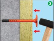
Пробурить отверстие в стеновом материале основания через тепло-изоляционный материал. Вставить дюбель в просверленное Забить гвоздь. отверстие. Добить дюбель до плотного прилегания к теплоизоляционного прилегания к теплоизоляционному материалу.
