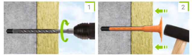
1 Пробурить отверстие через теплоизоляционный материал
