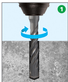
1 Пробурить отверстие в основании.
