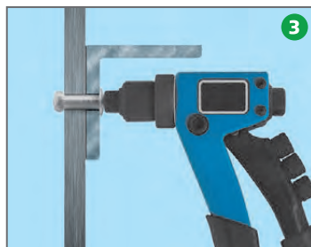
3 Приведите в действие заклепочник до разрыва сердечника.
