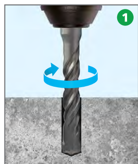
1 Пробурить отверстие в основании.
