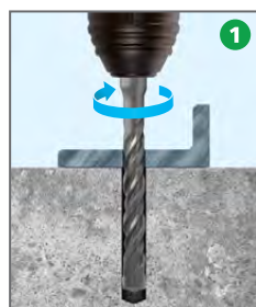
1 Пробурить отверстие в основании.
