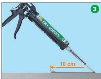
**3** Снимите с картриджа колпачок и установите насадку-смеситель. Установите картридж в пистолет. Произведите два качка для начала смешивания компонентов раствора.
