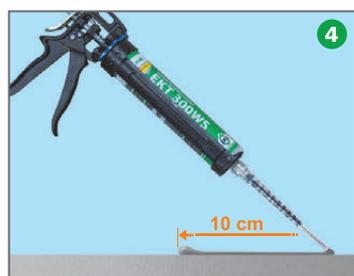
**4** Проведите раствором полоску до равномерного смешивания компонентов, данный раствор необходимо утилизировать, использовать его запрещается. В результате перемешивания компонентов раствора на выходе из смесителя образуется однородная масса.
